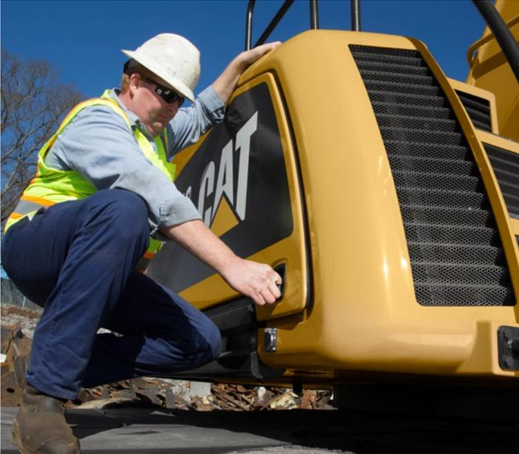
Para facilitar el servicio del modelo MH3049, todos los puntos de servicio primarios se encuentran convenientemente ubicados en un panel de servicio de un solo acceso en el lado derecho de la máquina o debajo del panel superior de acceso al motor. Ubique fácilmente los componentes con el diseño longitudinal del motor y del sistema de enfriamiento. Ambos paneles tienen bisagras con montantes de gas, lo que garantiza que un técnico pueda acceder fácilmente a todos los puntos de mantenimiento.
