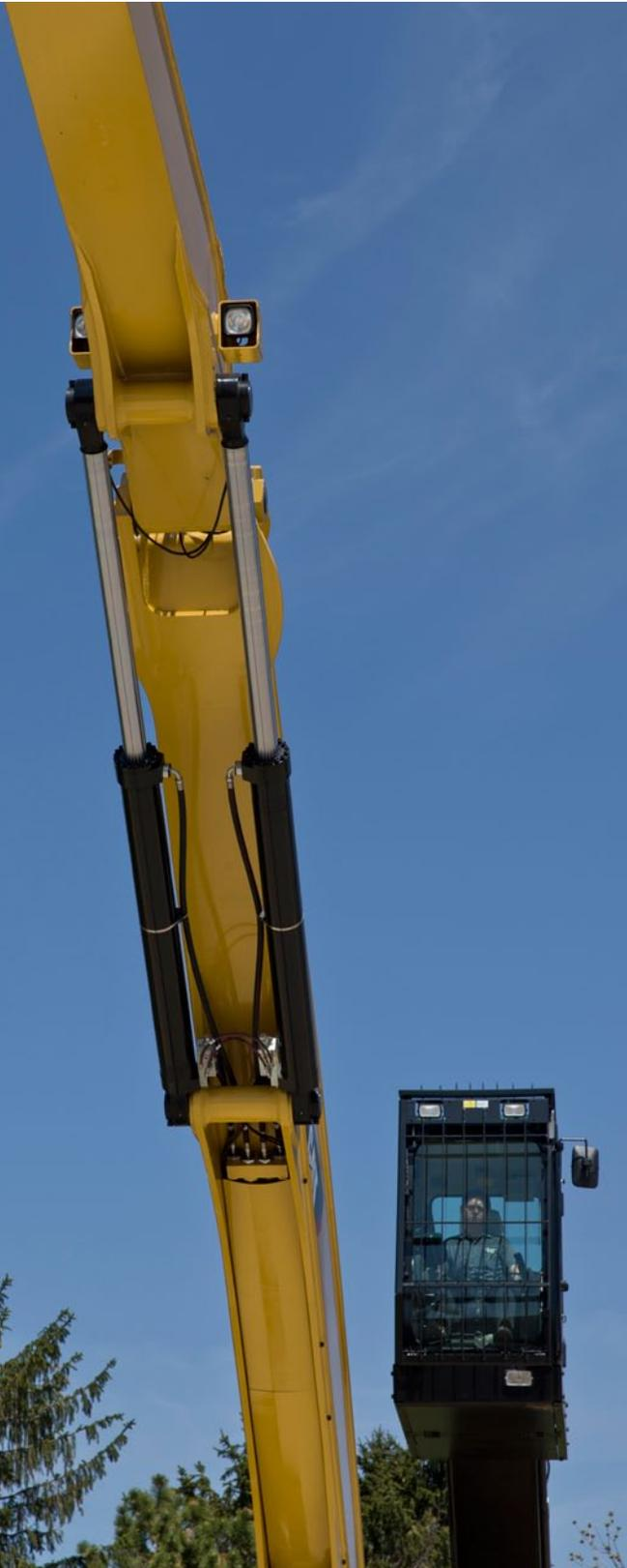
Usted es consciente de que un manipulador de materiales solo trabaja tan adecuadamente como su varillaje delantero es capaz de manejar el trabajo. La pluma y brazo del modelo MH3059 están fabricados especialmente para las cargas que se encuentran en aplicaciones de manipulación de materiales a granel, y cuentan con la capacidad para soportar condiciones extremas de carga.
