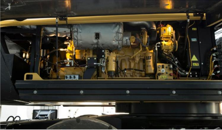
Para facilitar el servicio del modelo MH3059, todos los puntos de servicio primarios se encuentran convenientemente ubicados debajo de un panel de servicio acceso sencillo en el lado derecho de la máquina o debajo del panel superior de acceso al motor. Ubique fácilmente los componentes con el diseño longitudinal del motor y del sistema de enfriamiento. Ambos paneles tienen bisagras con montantes de gas, lo que garantiza que un técnico pueda acceder fácilmente a todos los puntos de mantenimiento.
