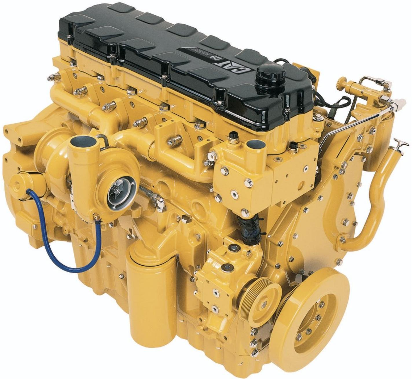
Más potencia cuando la necesite, el Motor ACERT Cat C9 de gran cilindrada permite optimizar el rendimiento de la máquina y aumentar la eficiencia del combustible mientras cumple con las regulaciones sobre emisiones Tier 3/Stage IIIA. El modelo C9 es un motor de 6 cilindros en línea con cilindrada de 8,8 L (537 pulg<sup>3</sup>) y una potencia nominal de 242 kW (325 hp). Este motor probado en el mercado, produce suficiente potencia para ejecutar operaciones simultáneas de la máquina.
