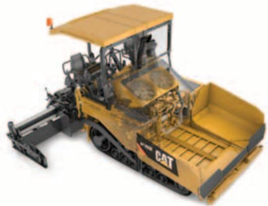
visibilidad clara para lograr un óptimo rendimiento. Los operadores aprecian las estaciones independientes que se extienden fuera del bastidor en ambos lados, así como los correspondientes mandos móviles.
