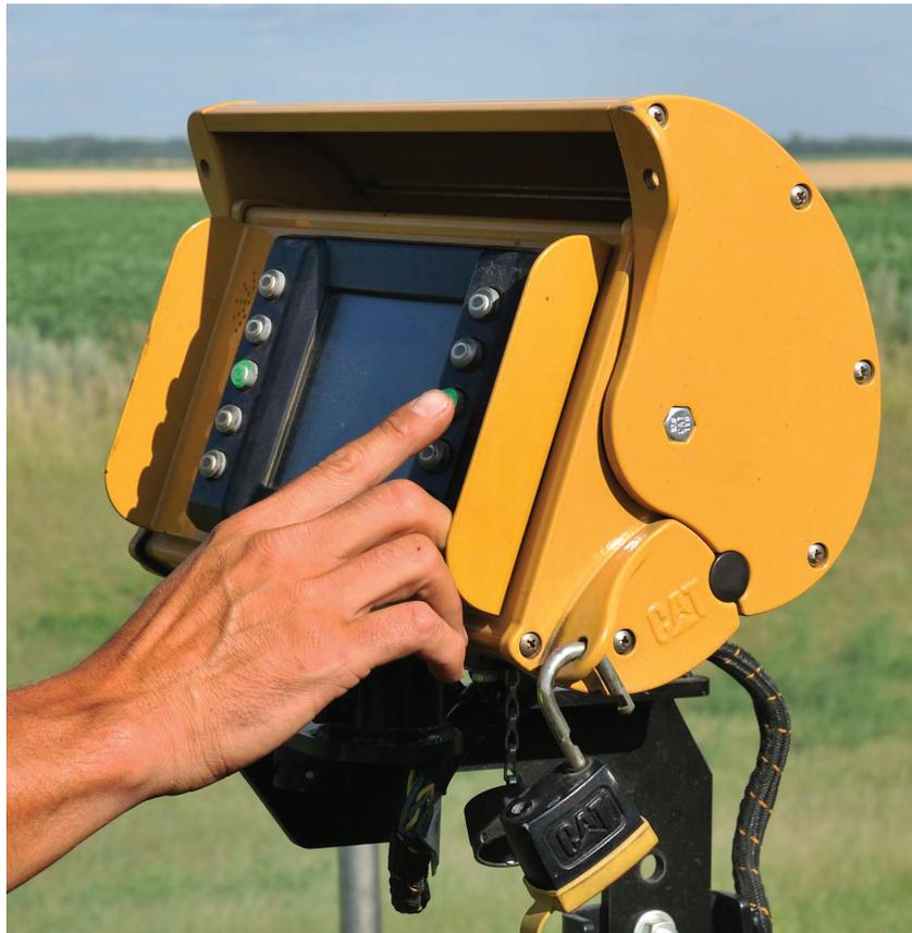
El sistema permite al operador extender la cantidad exacta de mezcla.
