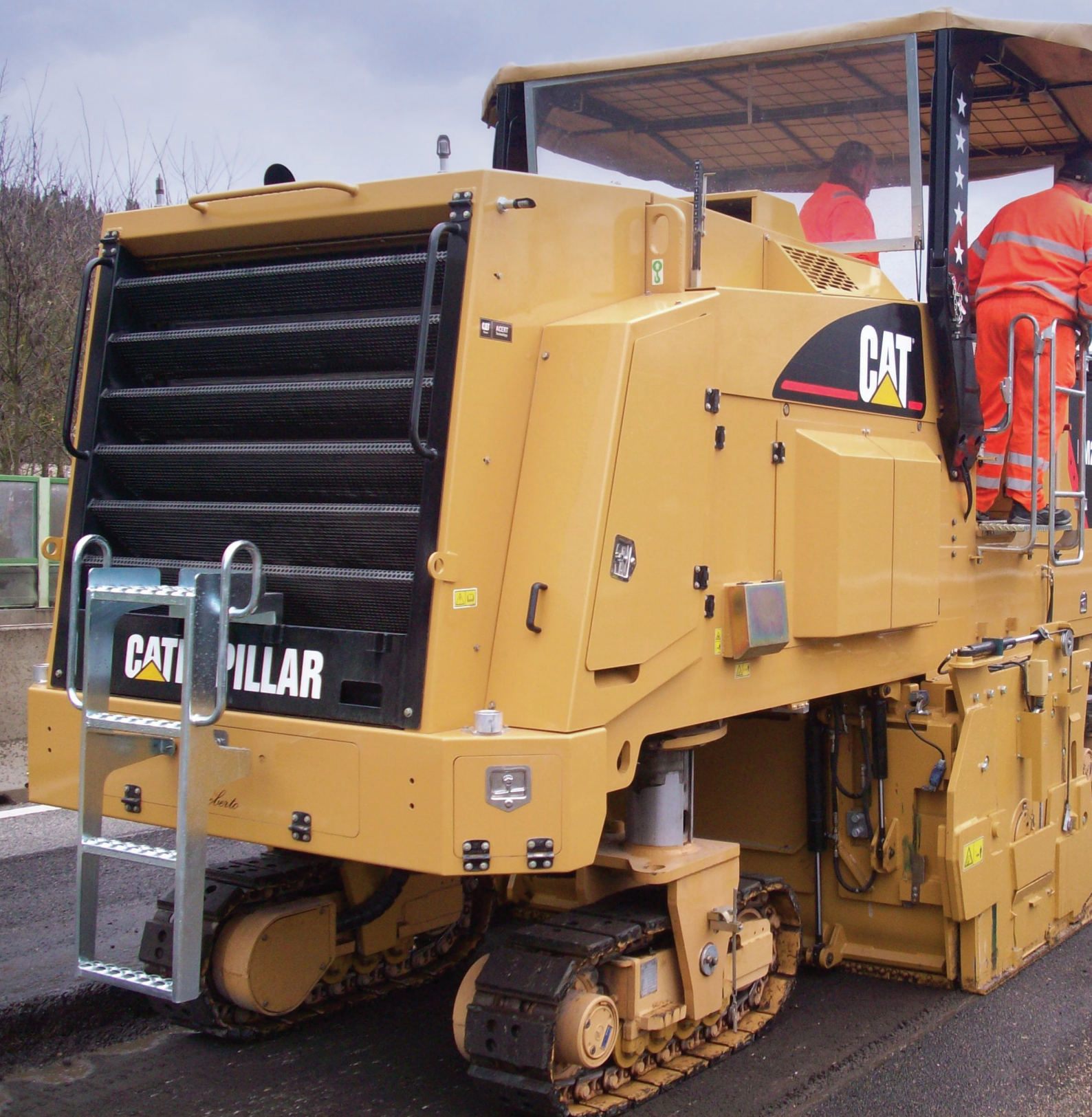
Le tambour de 2,2 m de large a permis de fraiser les chaussées de l'autoroute E78 en 4 passes contre 5.
