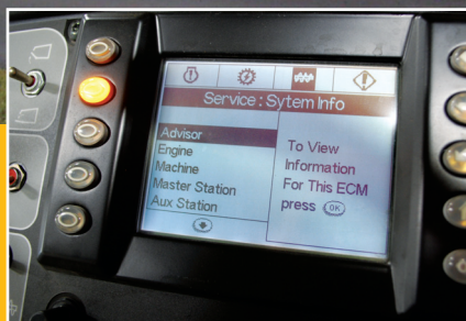
◀ Les écrans d'affichage sur les nouvelles machines, comme le finisseur Cat® AP555E, sont conviviaux et présente des informations pour faciliter le dépiage des pannes.
