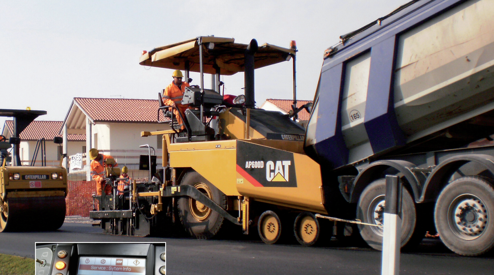
◀ Bildschirmanzeigen bei neuen Produkten, wie dem Cat® AP555E Asphaltfertiger, sind bedienerfreundlich und liefern Hinweise zur schnellen Störungsbehebung.
