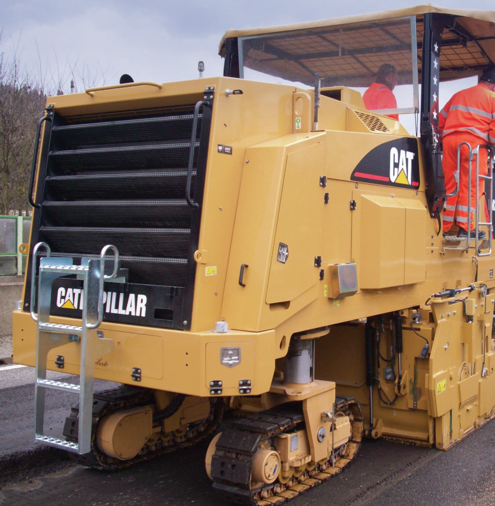
⚡ Die 2,2-m-Walze ermöglichte den Fräseinsatz auf der E78 in vier statt fünf Übergängen
