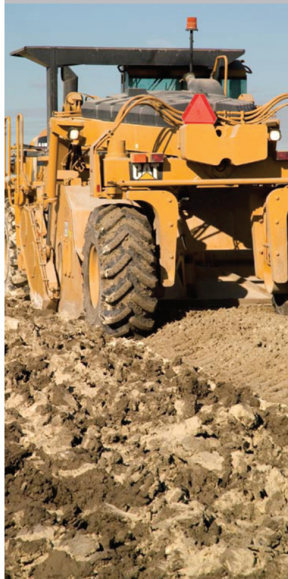
^ Wichtige Vorteile des RM500 sind, nach Angaben von Mitarbeitern, das Planieren bei Landgewinnungsarbeiten und der Einmischungsgrad bei Stabilisierungsarbeiten.
