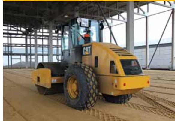
Il compattatore vibrante monotamburo CS533 al lavoro in un futuro magazzino.
