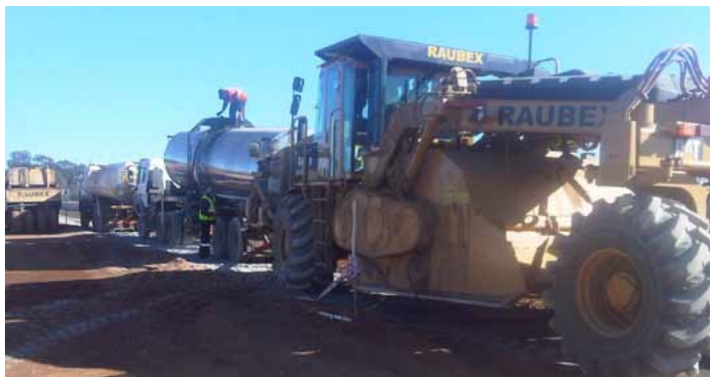
▲ A RM500 estabilizadora de solos tem força suficiente para puxar dois tanques de água.
