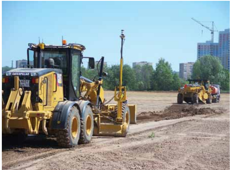
↗ A recicladora RM500 e o camião de alimentação são seguidos pela motoniveladora da Cat®.
