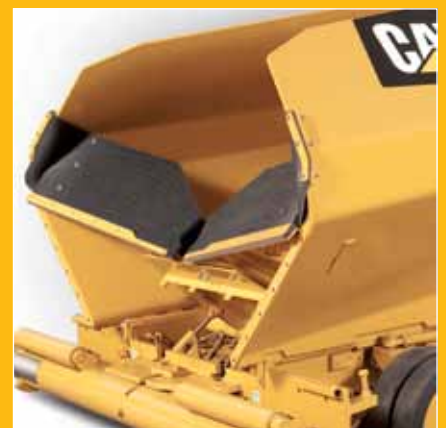
^ Le tablier avant pliable et sa commande hydraulique en option simplifient le nettoyage.
