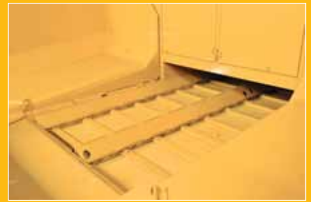
^ Les raclettes des convoyeurs ont un espacement faible pour assurer un écoulement régulier.
