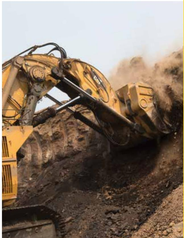
Hydraulikzylinder, werden sämtliche Vorteile des Frontdesigns von Cat genutzt, und gleichzeitig werden routinemäßige Wechsel von Vorschub- und Rückziehseilen überflüssig. Dies führt zu erhöhter Sicherheit und geringeren Ausfallzeiten dank weniger Wartungsereignissen.
