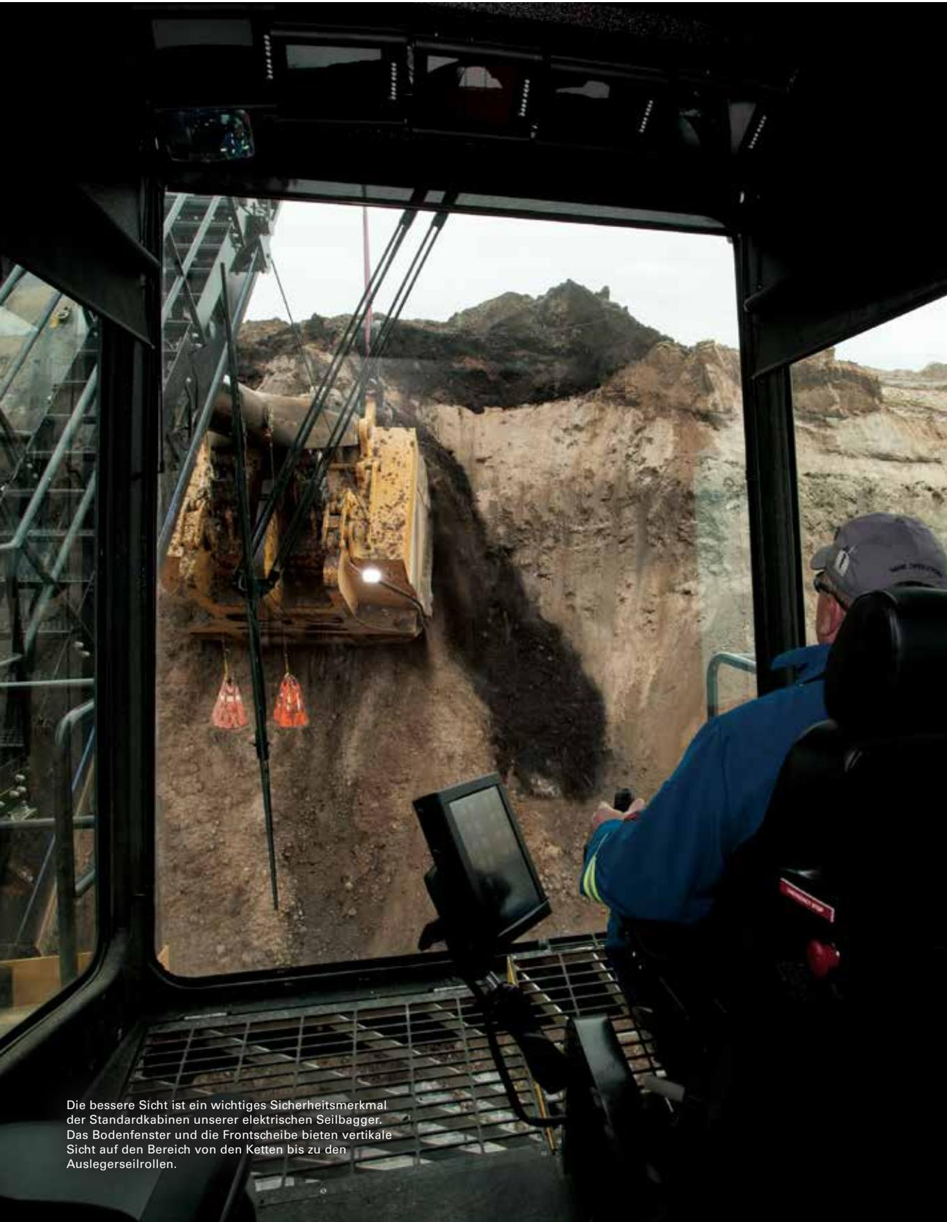
Die bessere Sicht ist ein wichtiges Sicherheitsmerkmal der Standardkabinen unserer elektrischen Seilbagger. Das Bodenfenster und die Frontscheibe bieten vertikale Sicht auf den Bereich von den Ketten bis zu den Auslegerseilrollen.
