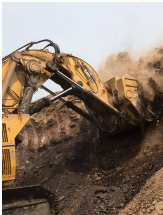
hydraulique du secteur doté d'un vérin hydraulique à l'intérieur du bras de godet tubulaire, conserve tous les atouts de l'extrémité avant Cat en éliminant la nécessité de remplacer régulièrement les câbles de poussée et de rétractation. Les opérations d'entretien sont donc moins fréquentes, ce qui contribue à améliorer la sécurité et à réduire les immobilisations.
