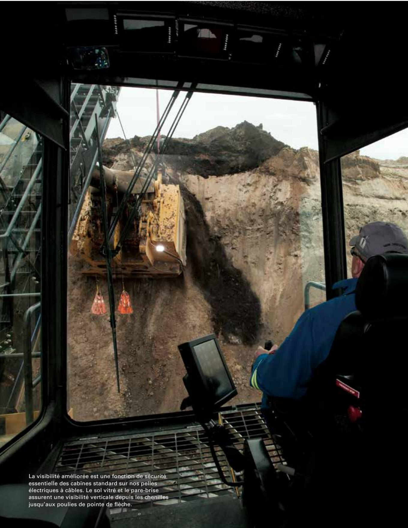
La visibilité améliorée est une fonction de sécurité essentielle des cabines standard sur nos pelles électriques à câbles. Le sol vitré et le pare-brise assurent une visibilité verticale depuis les chenilles jusqu'aux poulies de pointe de flèche.
