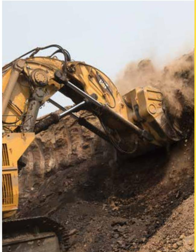
Cat 矿用铲融合了多种有助提高生产力的高级功能，并充分利用了最新的技术，可以提高安全性和装载准确性，并改进整个矿场作业。像独特的 TriPower 系统（如右侧两张照片中所示）这样的功能，可以为正在执行挖掘作业的液压正铲提供更高的稳定性和更大的动力。
