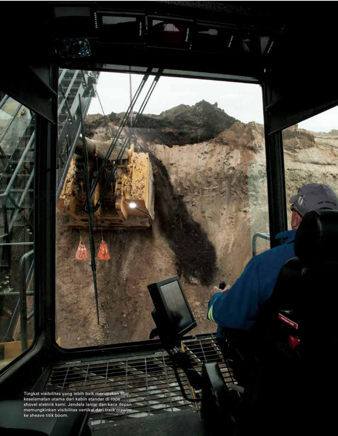
Tingkat visibilitas yang lebih baik merupakan fitur keselamatan utama dari kabin standar di rope shovel elektrik kami. Jendela lantai dan kaca depan memungkinkan visibilitas vertikal dari track crawler ke sheave titik boom.
